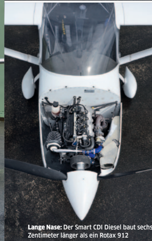
Klein, aber komplex: Der Smart-Flugmotor hat nur 800 Kubikzentimeter Hubraum
